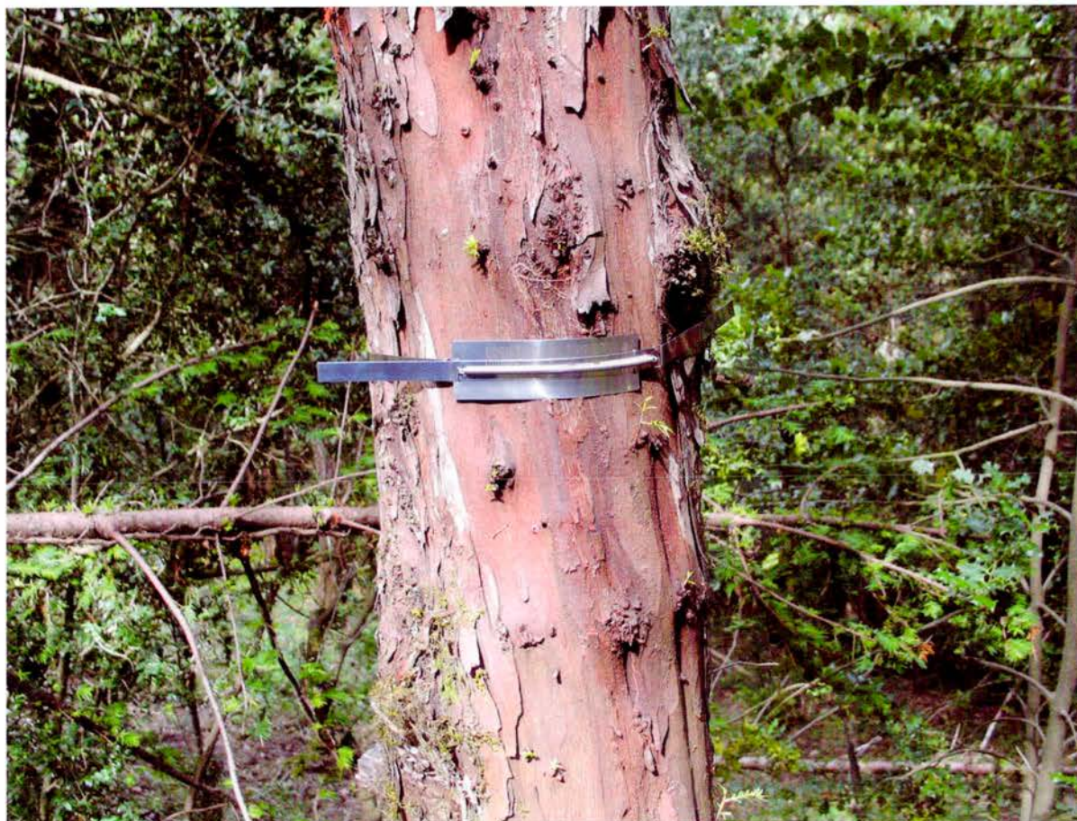
Figura 2: Dendròmetre de banda pel seguiment mensual de la variació del diàmetre en relació a l'efecte del tractament de poda a la teixeda de Misaclòs.
